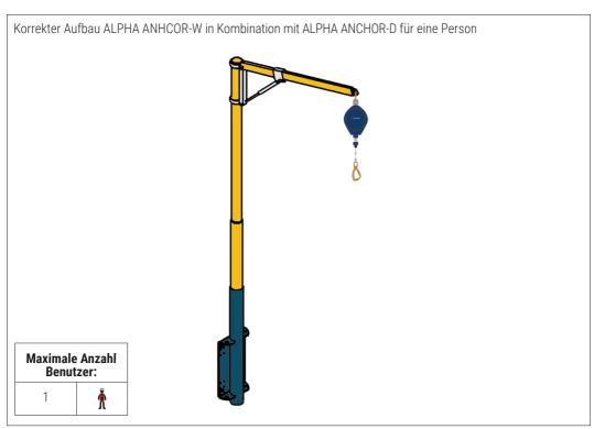
Auf der nächsten Seite wird der korrekte Montage der festmontierten Anschlageinrichtung Typ ALPHA ANCHOR-W in Kombination mit ALPHA ANCHOR-D für eine Person dargestellt.
