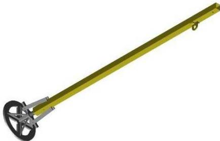
**Montant secondaire** : tube 40x40 cm en acier inox AISI 304 de 2 mm d'épaisseur et 170 cm de longueur.
