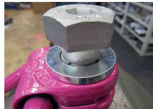
Abb. 9: Sprengring umlaufend vertieft in der Ansenkung positioniert
