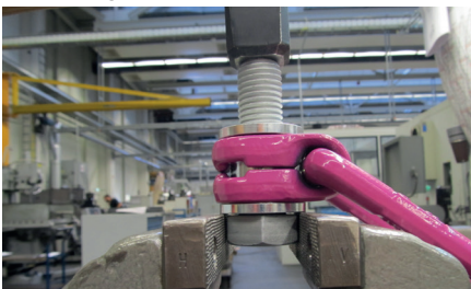
Abb. 7: Auflage des VLBG zur Demontage der Schraube
