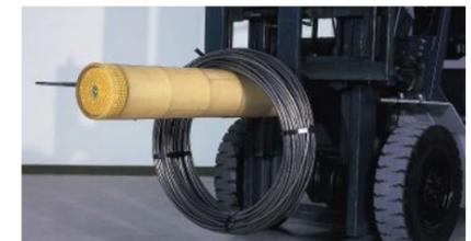
Rohrmodule für Staplerdorn
