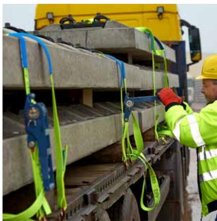
**Sangle d'arrimage 50 mm type ZK50 à tendeur ERGO-ABS (EN12195-2)**
