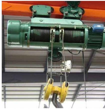
**Câble acier galvanisé surtréfilé Âme métallique Nuance 2160 N/mm<sup>2</sup> Câblage lang à droite**
